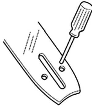
Fig. 24 – Limpeza do furo de lubrificação
