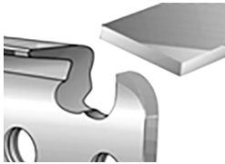
Fig. 23 – Arredondeado de lo salto del corte
