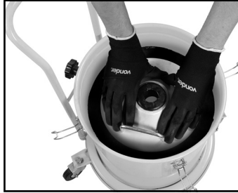
Figura 3 – Empurre a placa compactadora
