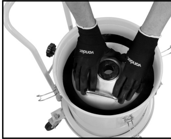
Figura 3 – Empuje la placa compactadora
