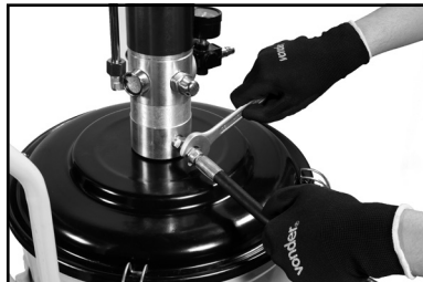
Figura 5 – Fixação da mangueira na bomba
