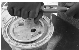
Fig. 2 – Rehaciendo la rosca con el macho
