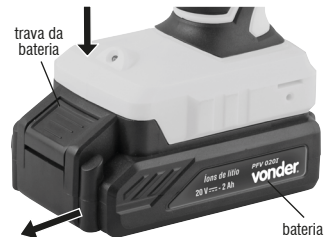
Fig. 2 – Retirando a bateria
