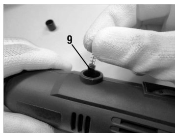
Fig. 6 – Sustitución de cepillo carbón
