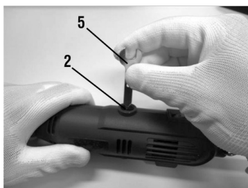
Fig. 6 – Sustitución de cepillo carbón
