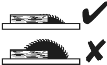
Fig. 8 – Ajuste de altura de corte de la lámina
