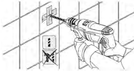
fig. 8 - perfuração em cerâmicas esmaltadas (porcelanato)
