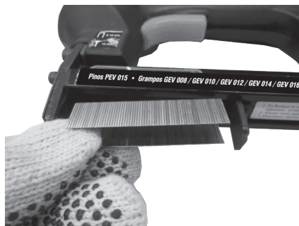
Fig. 4 – Posicionamento dos pinos/grampos
