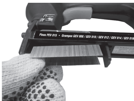
Fig. 4 - Posicionamiento de los clavos/grapas
