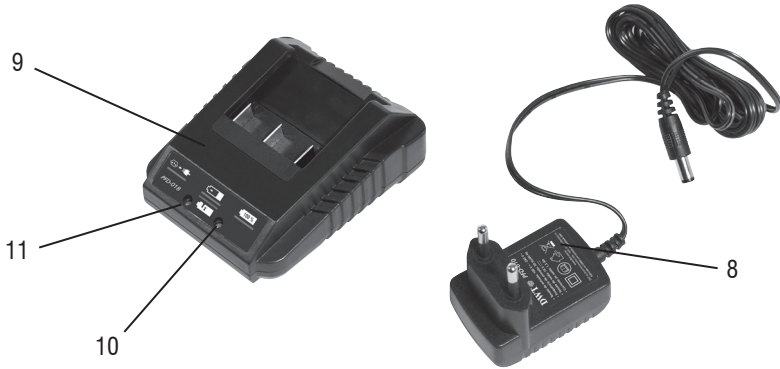
Fig. 1 – Componentes da Parafusadeira/Furadeira PFD-018 (18 V)
