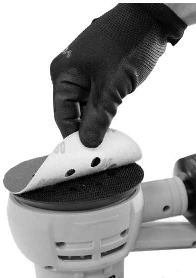
Fig. 3 – Extracción de la lija
