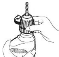
Fig. 4 – Demostrativo para soltar el mandril de apriete rápido
