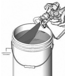
Figura 6 – Manteniendo la continuidad del aterramiento
