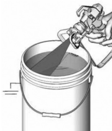
Figura 6 – Mantendo a continuidade do aterramento
