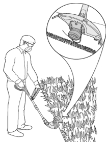
Fig. 11 – Aparar bordas com auxílio da roda
