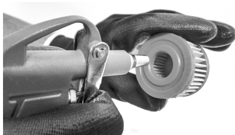
Fig. 18 – Remoção e limpeza do filtro
