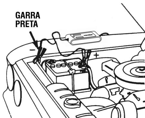
Fig. 7 – Carregando bateria no veículo
