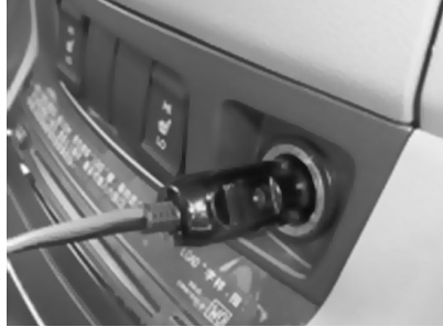
Fig. 9 – Carga a través de la toma 12 V
