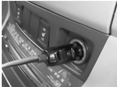
Fig. 9 – Carregamento através da tomada 12 V
