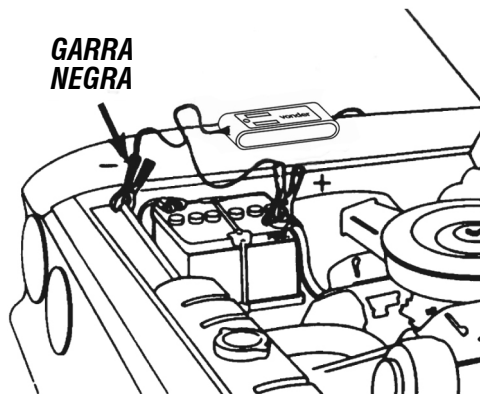
Fig. 7 – Cargando la batería en el vehículo
