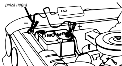
Fig. 6 – Cargar la batería en el vehículo
