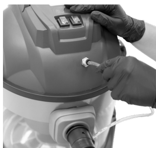
Fig. 12 – Inserindo a mangueira no conector rápido
