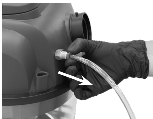
Fig. 10 – Quitar la manguera del conector rápido
