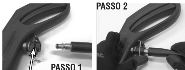
Fig. 6 – Montagem da mangueira de alta pressão
