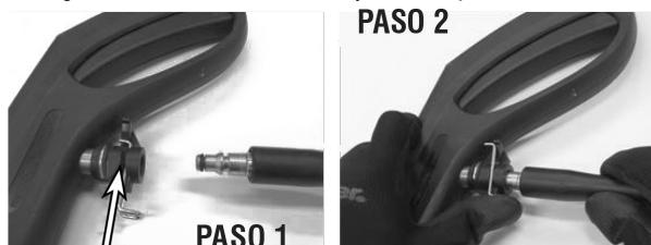
Fig. 6 – Montaje de la manguera de alta presión
