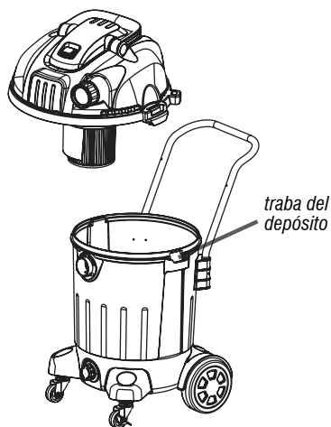
Fig. 24 – Extracción del cabezal del depósito
