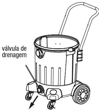
Fig. 27 – Válvula de drenagem
