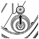
Fig. 21 – Limpieza de los filtros de esponja
