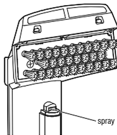
Fig. 22 – Verificar spray de água dos bocais
