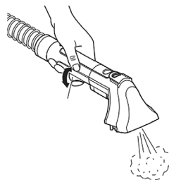
Fig. 19 – Removendo o restante da água presente no sistema
