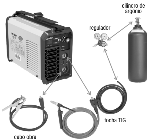
Fig. 3 – Montagem do conjunto
