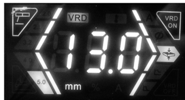
Fig. 4 – Ajuste em função da espessura da chapa
