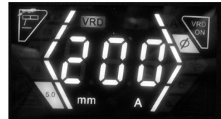
Fig. 3 – Ajuste según el calibre del electrodo
