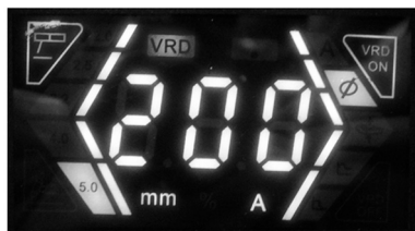
Fig. 3 – Ajuste em função da bitola do eletrodo
