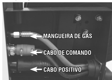
Fig. 4 – Conexão do conjunto de cabos
