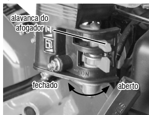
Fig. 7 – Alavanca do afogador
