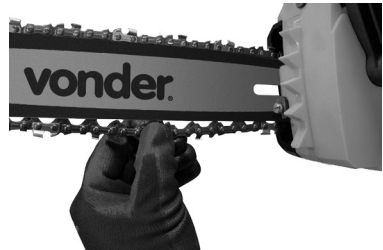
Fig. 6 – Ajuste de juego de la cadena
