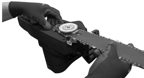
Fig. 5 – Montaje del sable y cadena de corte
