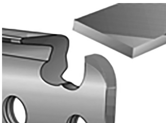
Fig. 26 – Arredondando o salto de corte
