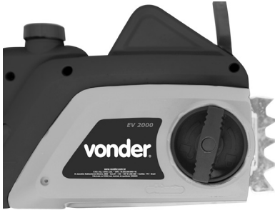
Fig. 3 – Removendo a tampa do sabre da corrente
