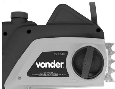
Fig. 3 – Removiendo la cubierta del sable de la cadena
