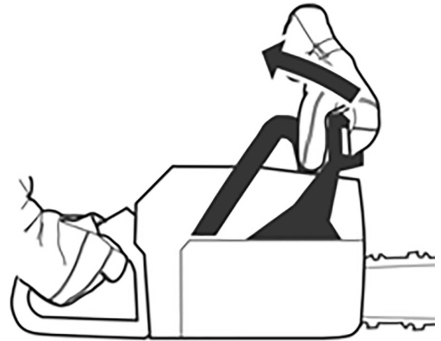
Fig. 34 – Desbloqueando la cadena
