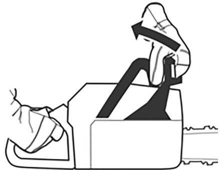
Fig. 34 – Destravando a corrente
