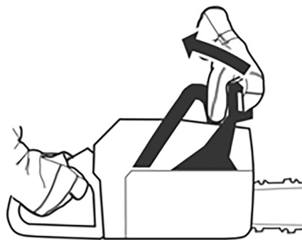
Fig. 31 – Destravando o freio da corrente
