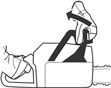
Fig. 31 – Destrabando el freno de la cadena
