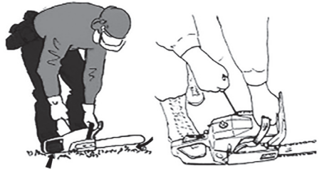
Fig. 28 – Ligando a motosserra no chão
