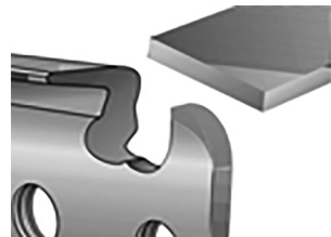
Fig. 42 – Arredondear salto de corte
