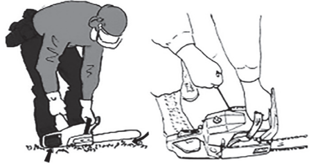
Fig. 28 – Encendiendo la motosierra en el suelo
