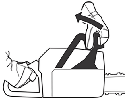
Fig. 34 – Destravando a corrente
