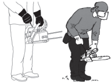
Fig. 29 – Ligando a motosserra entre joelhos
