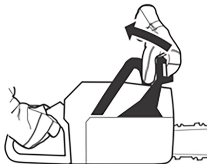
Fig. 31 – Destravando o freio da corrente
