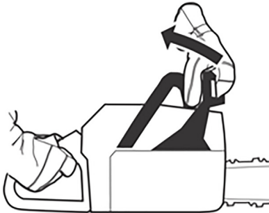
Fig. 31 – Destrabando el freno de la cadena
