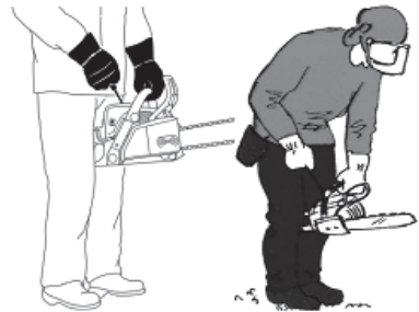
Fig. 29 – Encendiendo la motosierra entre rodillas
