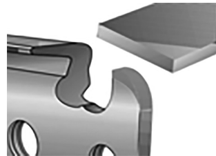
Fig. 42 – Arredondar salto de corte
