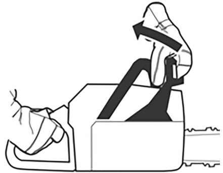
Fig. 34 – Desbloqueando la cadena
