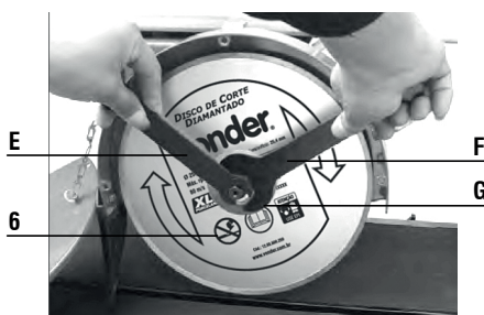
Figura 9 – Instalação do disco
