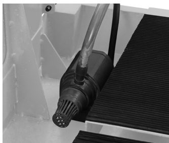
Figura 11 – Bomba de agua
