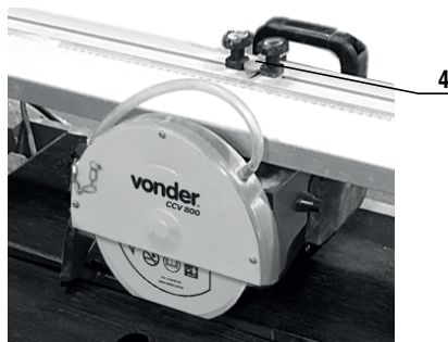
Figura 3 – Cabeçote fixo, evitando o deslocamento involuntário
