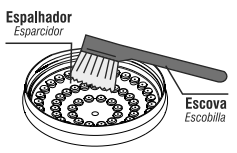
Figura 05 – Limpeza do espalhador
