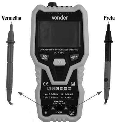
Fig. 5 – Instalação pontas de prova - Capacitância
