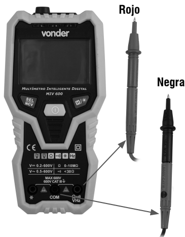
Fig. 4 – Instalación puntas de prueba: tensión AC y DC, resistencia
