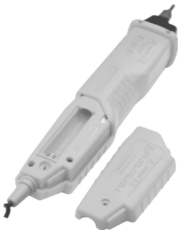
Fig. 3 – Compartimento das pilhas
