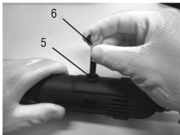
Fig. 6 – Substituição da escova de carvão
