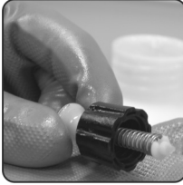
Fig. 11 – Verificar la válvula de seguridad
