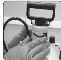
Fig. 3 – Retirar la bomba (pistón y cilindro)
