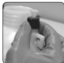
Fig. 10 – Verificar la válvula de seguridad
