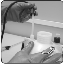
Fig. 12 – Desconectar a mangueira do reservatório
