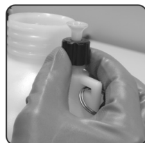
Fig. 10 – Verificar a válvula de segurança
