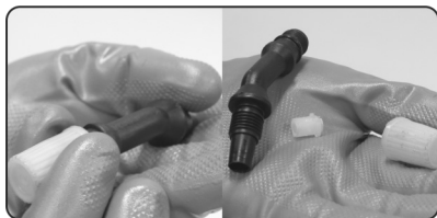
Fig. 18 – Desmontar la conexión del pico
