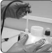
Fig. 12 – Desconectar la manguera del depósito
