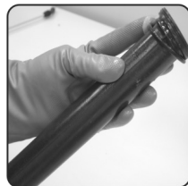
Fig. 8 – Substituir el anillo de sellado oring
