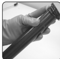
Fig. 8 – Substituir anel de vedação/oring
