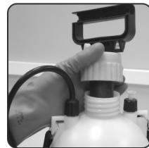
Fig. 4 – Retirar a bomba (pistão e cilindro)
