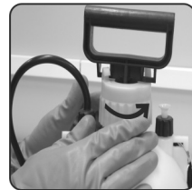
Fig. 3 – Retirar a bomba (pistão e cilindro)
