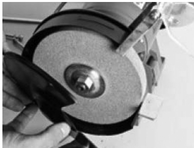
Fig. 6 – Eliminación de la tapa de la muela
