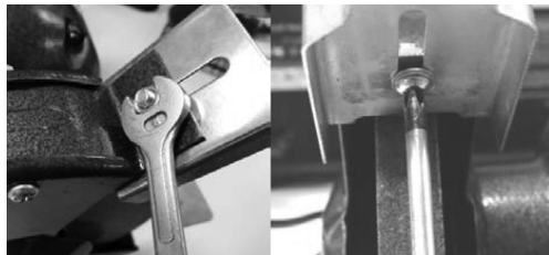
Fig. 2 – Montaje del visor de protección
