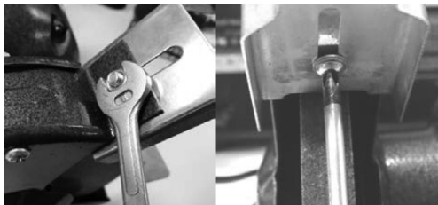
Fig. 2 – Montagem do Visor de Proteção
