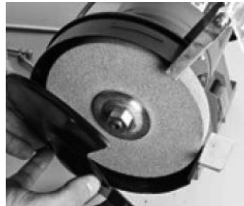
Fig. 6 – Remoção da tampa do rebolo
