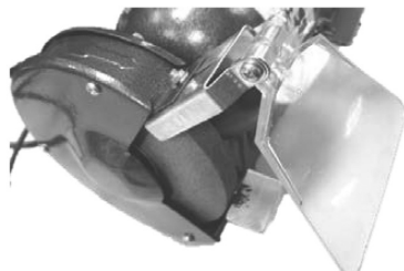
Fig. 3 – Regulagem do Visor de Proteção
