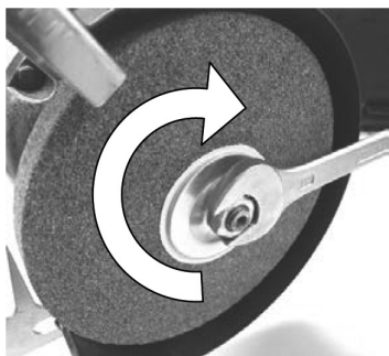
Fig. 7 – Tuerca de fijación de la muela
