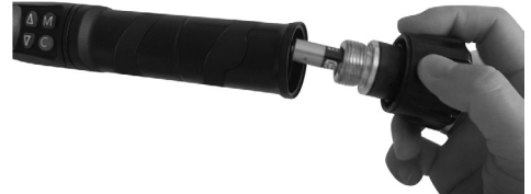
Fig. 9 – Sustitución de la batería
