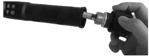
Fig. 10 – Substituição das pilhas
