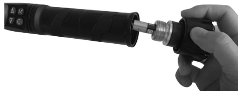
Fig. 10 – Sustitución de las pilas
