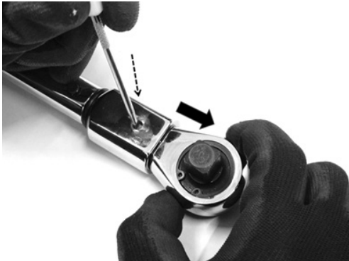
Fig. 3 – Retirar la punta intercambiable
