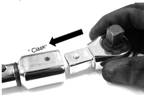
Fig. 2 – Encaixando a ponta intercambiável
