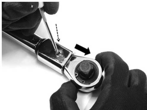
Fig. 3 – Retirando a ponta intercambiável
