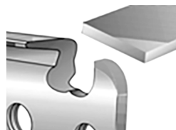
Fig. 17 – Arredondando o salto de corte
