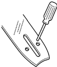
Fig. 18 – Limpeza do furo de lubrificação
