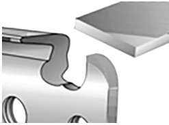
Fig. 17 – Arredondeado de lo salto del corte
