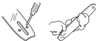
Fig. 6 – Limpeza do furo de lubrificação e canal do sabre
