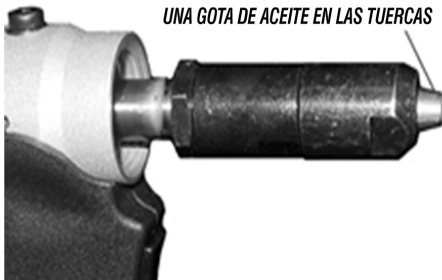
Fig. 15 – Lubricación de las tuercas
