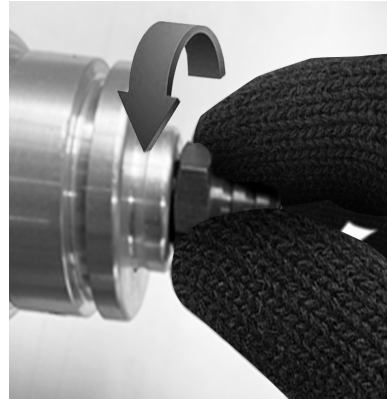
Fig. 2 – Ligando a válvula de vácuo: sentido anti-horário
