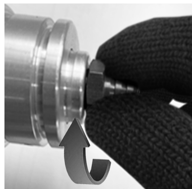
Fig. 3 – Cierre de la válvula de vacío: en el sentido de las agujas del reloj
