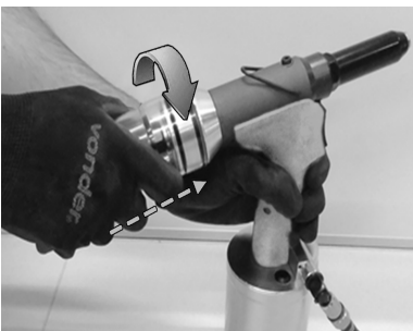
Fig. 10 – Reposicionamiento del depósito
