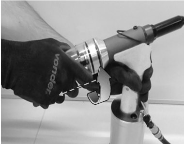
Fig. 9 – Desmontaje del depósito
