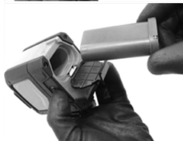
Fig. 2 – Inserindo/removendo a bateria
