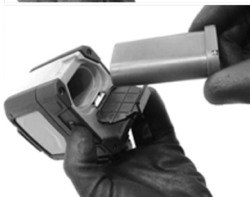
Fig. 2 – Inserción/extracción de la batería
