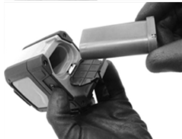
Fig. 2 – Inserción/extracción de la batería
