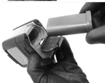
Fig. 2 – Inserindo/removendo a bateria
