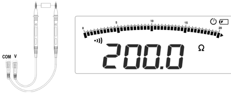
Fig. 13 – Medida de resistência e continuidade
