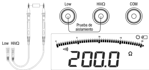
Fig. 14 – Prueba de aislamiento
