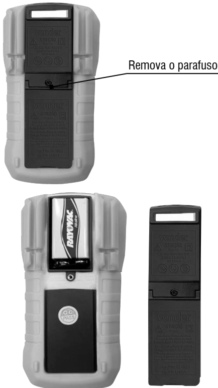
Fig. 3 – Substituição da bateria
