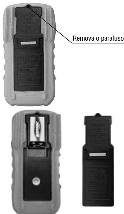
Fig. 3 – Substituição da bateria
