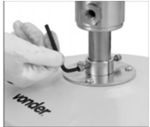
Fig. 3 – Montagem e fixação da tampa e bomba
