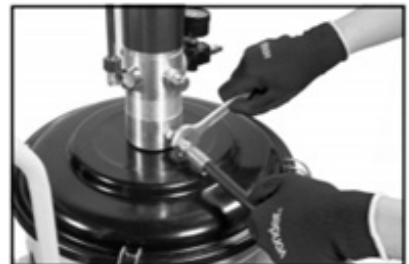
Fig. 4 – Fixação da mangueira na bomba
