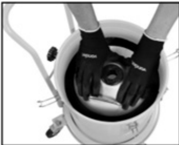
Fig. 2 – Empurre a placa compactadora
