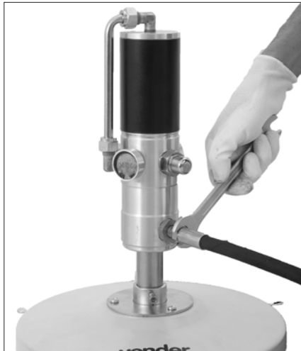
Fig. 4 – Fixação da mangueira na bomba
