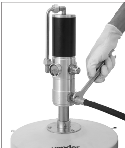
Fig. 4 – Fijación de la manguera en la bomba.
