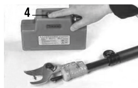
Fig. 3 - Montaje del tubo extensor
