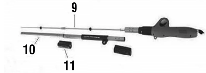
Fig. 8 – Montaje del tubo extensor
