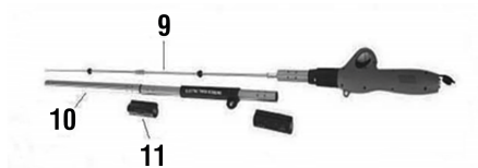
Fig. 8 – Montagem do tubo extensor
