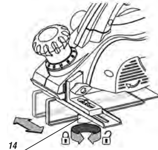
fig. 2 – ajuste de ancho de la guía lateral
