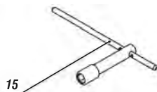
fig. 9 – llave para soltar la cuchilla
